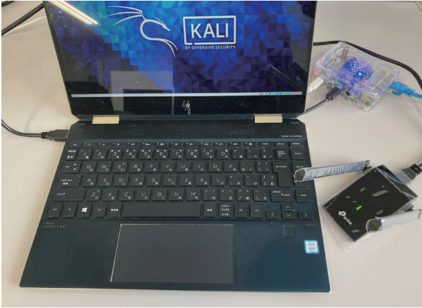
図1 2段階 EvilTwin 攻撃実験で実際に使用した装置 [3]
