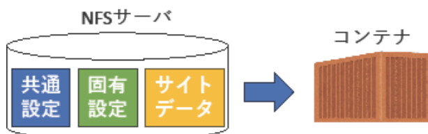
図2 第1期システムのデータ配置
