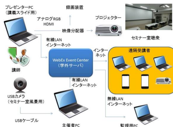
図1 配信システムの構成図 (映像)
