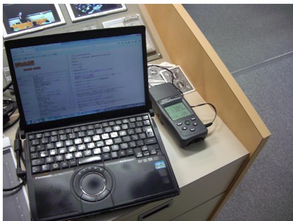
図3 ノートPCとデータロガー(ST-501N)の様子
