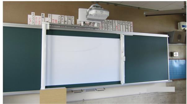
図 5 スライド式プロジェクタ型電子黒板
