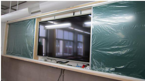
図 2 壁面固定式タッチパネル型電子黒板
