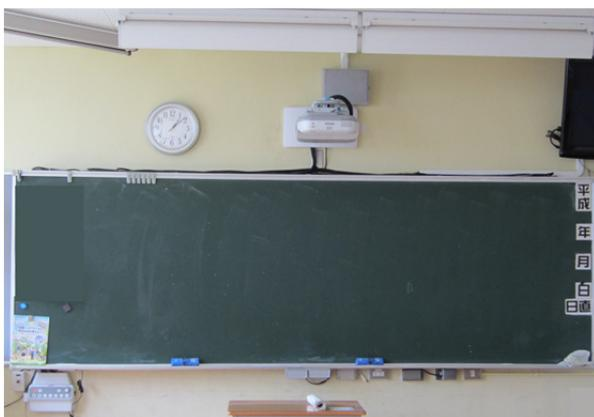
図 4 壁面固定式プロジェクタ型電子黒板
