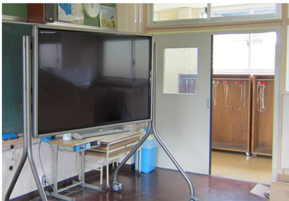
図 3 スタンド固定式タッチパネル型電子黒板
