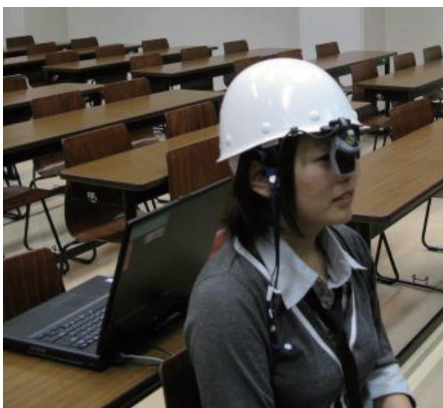
図1. 小型ヘッドマウントディスプレイを装着している様子。後方のノートパソコンからVGA出力で画面情報が片眼の約 60 cm前方に投影され
