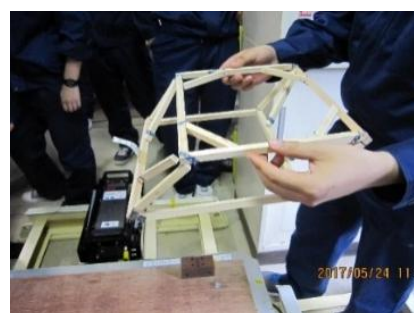
図5 木造軸組模型が倒壊して、壊れる
