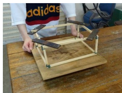
図4 木造軸組模型に錘を載せる
