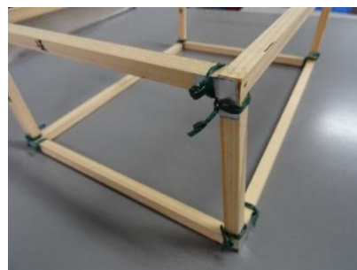
図3 柱・梁接合部の接合
