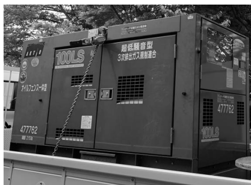
図3 可搬式ディーゼル発電機（100kVA）
