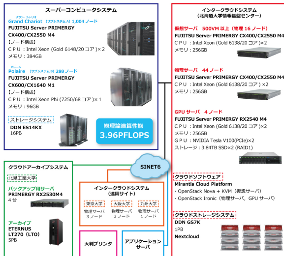
図 1：学際大規模計算機システム構成図
