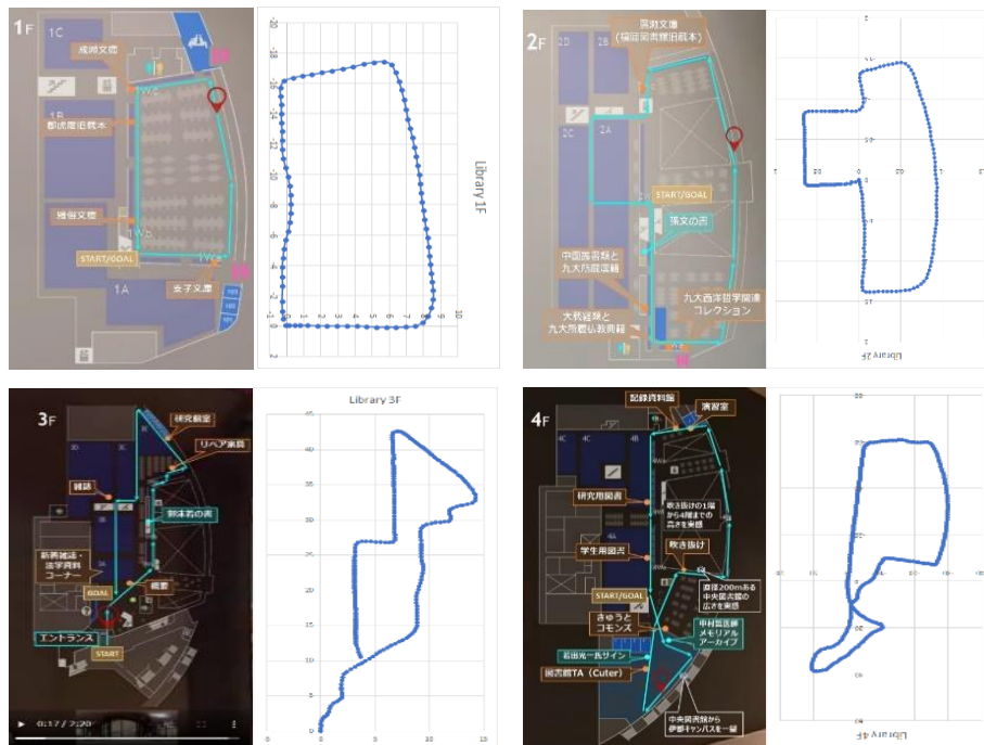
図7 手作業により作成された経路図と OpenVSLAM により自動抽出された経路
