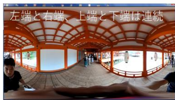
図 2 専用ソフトウェアを使用して魚眼レンズ画像から正距円筒画像を生成
