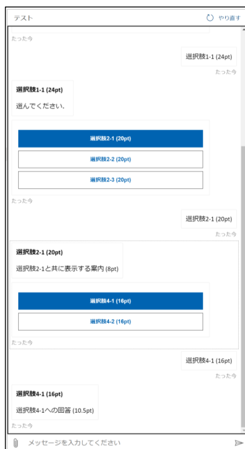
図 5 図 4 で示した汎用的 Q&A データから構築した選択肢型チャットボット動作の様子。質問と共に選択肢を表示し、利用者が選択すると (青色背景の選択肢が選択されたもの) 次の選択肢を提示する。最後に回答文を提示する。
