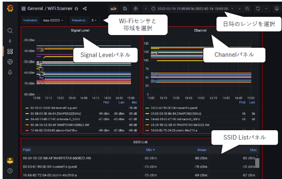
図3 可視化サーバのダッシュボード画面の例（電波強度調査）
