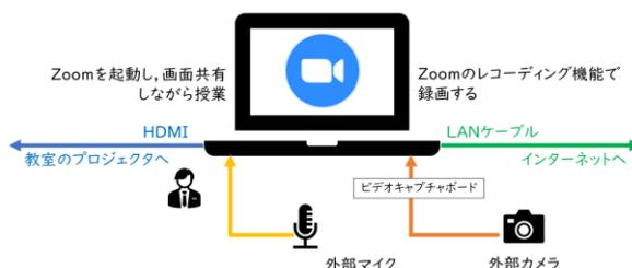
図 5. 外部カメラ・マイク接続の構成
