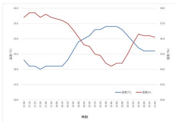
図4 LINPACK 測定時のシステム室温と湿度の推移
